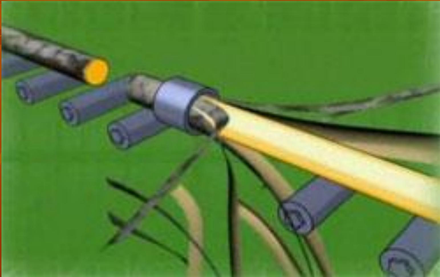
Самый экономичный способ получения древесной целлюлозы - механический: на деревообрабатывающем предприятии лесоматериалы измельчаются до крошки, которая смешивается с водой. Бумага, изготовленная на основе такой целлюлозы, непрочна и чаще всего идет на производство, например, газет.
