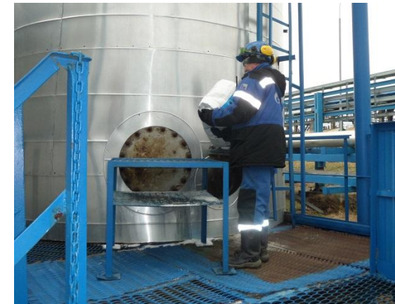
Загрузка антиокислительной присадки Агидол с использованием ручного труда
