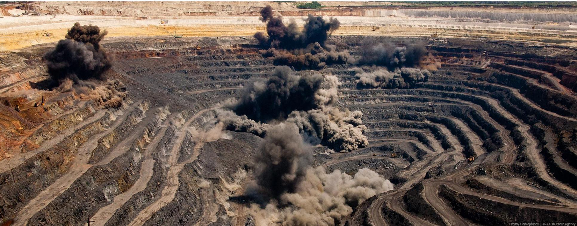
На данном фото видны следы взрыва ЭНМ с разным кислородным балансом
