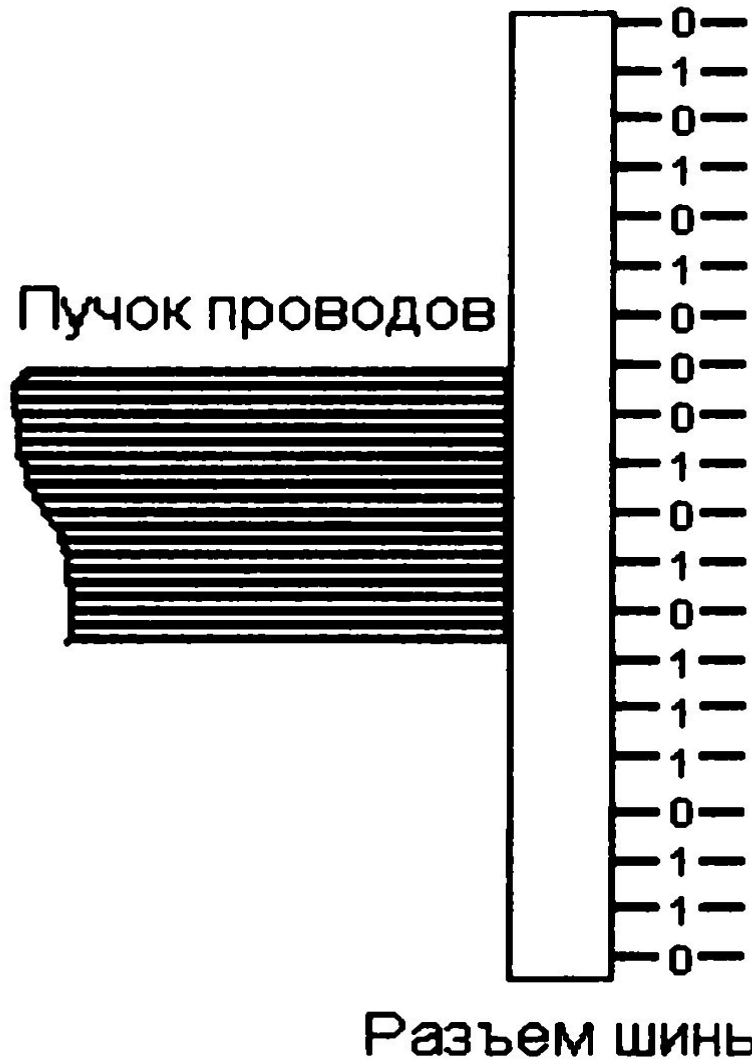
Рис. 4.3. Фрагмент двадцатиразрядной шины
