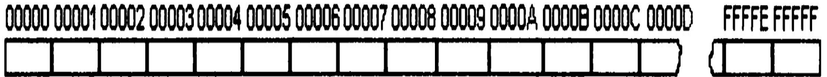
Рис. 4.4. Адреса байтов памяти в компьютере с двадцатиразрядной адресной шиной
