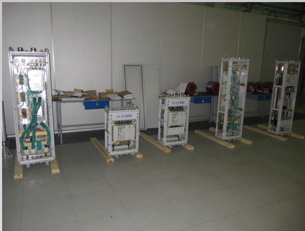
Шкафы преобразователей частоты ПЧ-ТПТКТР-38-360-50-125-1 и ПЧ-ТПТКТР-122-360-50-250-1
