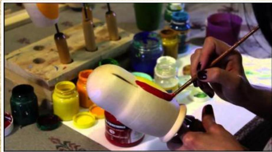
После токарной работы деревянную куклу тщательно зачищают, грунтуют клейстером, добиваясь идеально гладкой поверхности. После грунтовки матрёшка готова к росписи.
