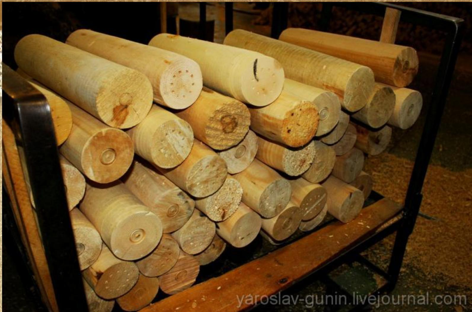
Дерево очищают от коры, обязательно оставляя кольца коры на стволе, иначе оно потрескается при сушке. Брёвна укладывают в штабель, оставляя между ними зазор для воздуха. Древесину выдерживают на открытом воздухе два года и более. Только опытный резчик может определить степень готовности материала.
