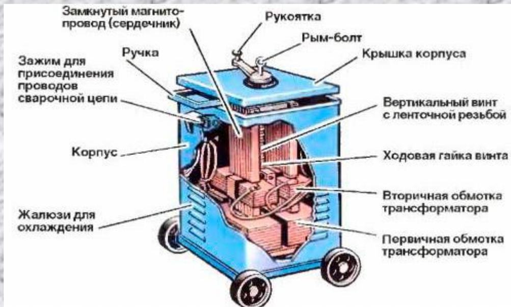
**Трансформатор для дуговой сварки строят на вторичное напряжение 60-70 В (напряжение зажигания дуги).**
