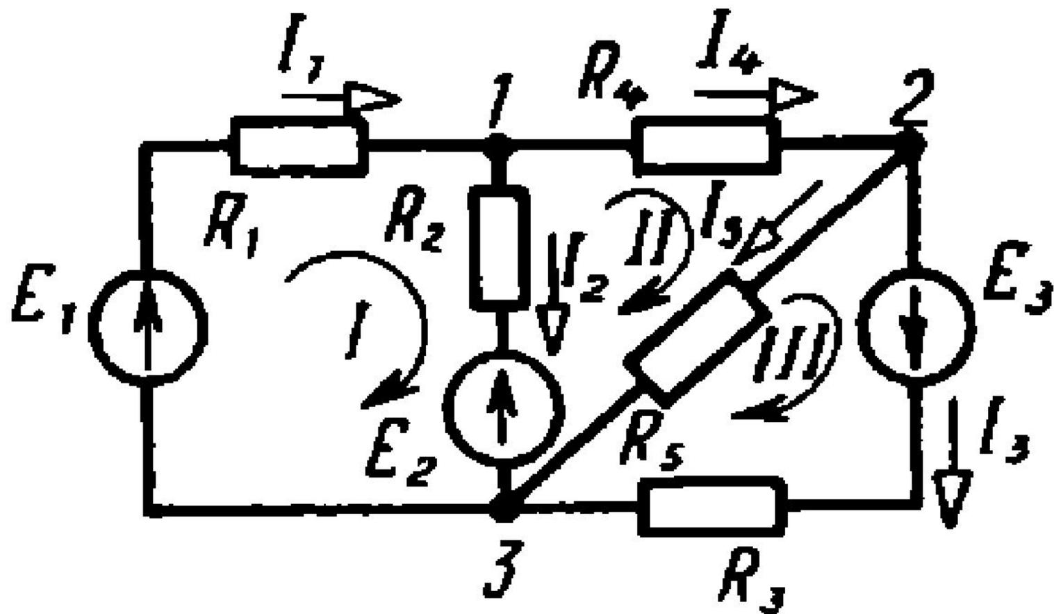
Рекомендуется следующий порядок составления уравнений по законам Кирхгофа: определяют число ветвей, узлов и независимых контуров, устанавливают число независимых уравнений по первому закону Кирхгофа, остальные уравнения составляются по второму закону Кирхгофа.
