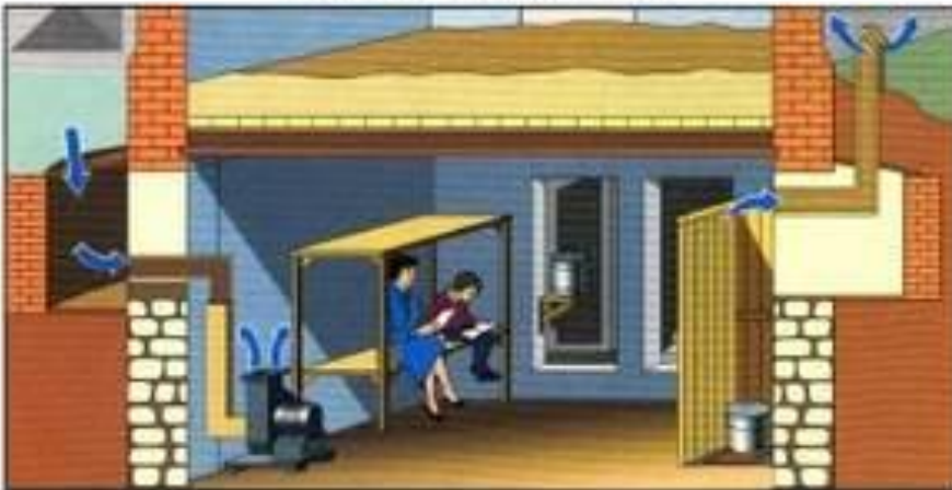
Подвал одноэтажного здания, приспособленный под противорадиационное укрытие
