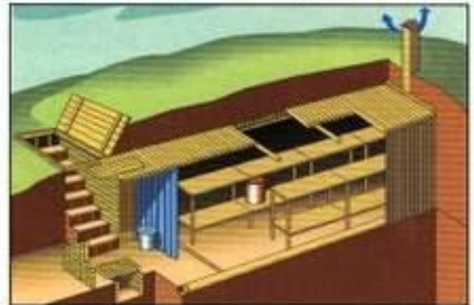
Отдельно стоящее противорадиационное укрытие из лесоматериалов
