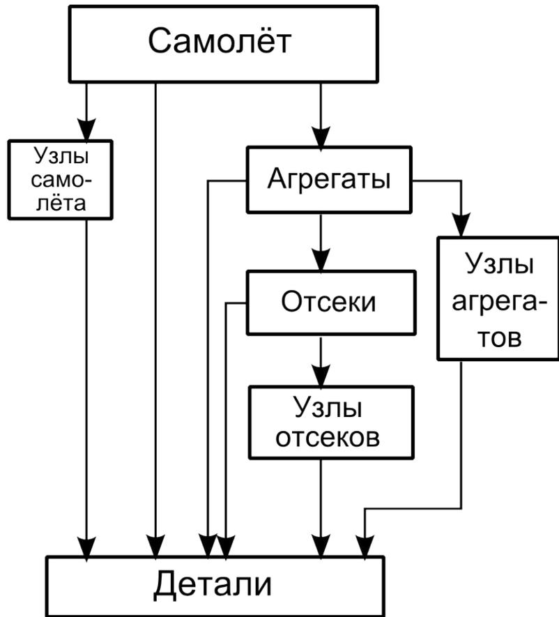
Принципиальная схема деления самолета на составные части
