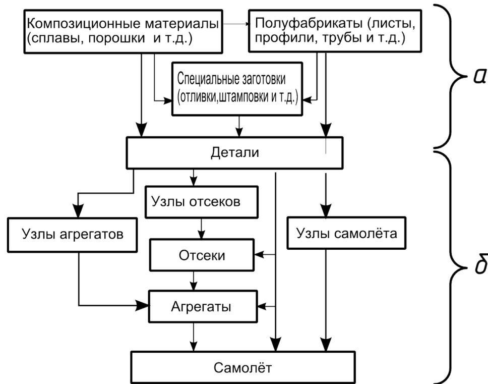
Принципиальная схема преобразования исходных материалов в планер самолета:
