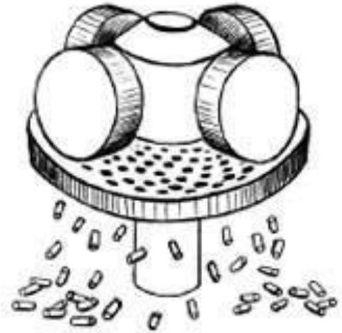
Существует 2 типа грануляции: роторного типа и дисковый. Преимущество роторного - высокая производительность.
