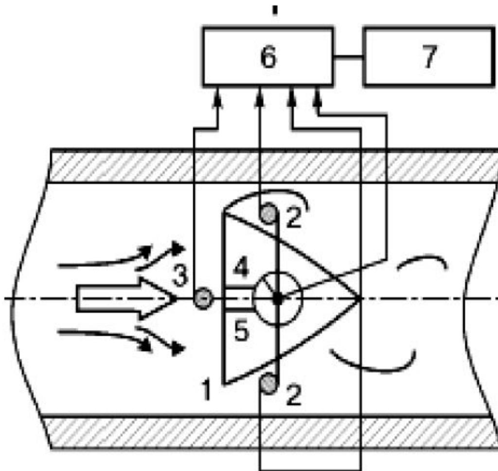
1 – тело обтекания; 2 – преобразователь пульсаций давления; 3 – преобразователь избыточного давления; 4 – термопреобразователь; 5 – отверстия; 6 – плата цифровой обработки; 7 – вычислитель.
