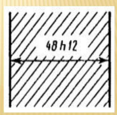
Если для написания размерного числа мало места над размерной линией, размерное число наносят по одному из вариантов, на рисунке.
