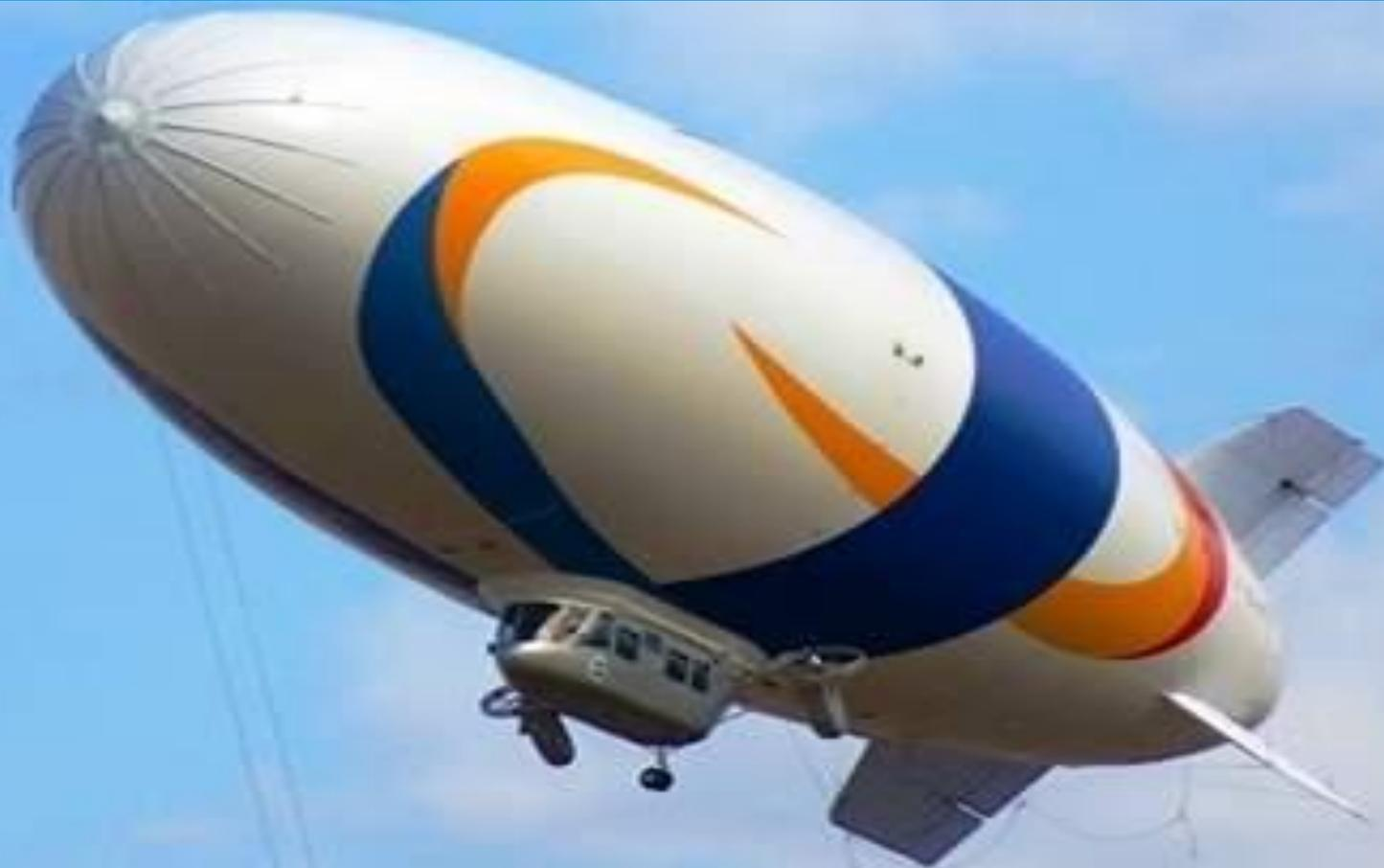
**Дирижабль - летательный аппарат легче воздуха (наполнен газом, который легче воздуха), с двигателем, благодаря которому дирижабль может двигаться независимо от направления воздушных потоков.**
