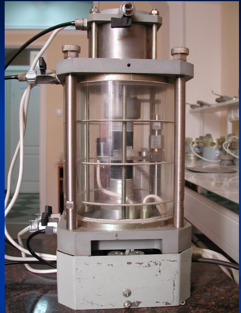
Схема и общий вид стабилометра – прибора для трехосных испытаний грунта
