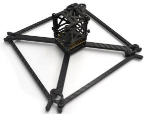
Рама типа Квадрат: между лучами добавили соединяющие их рёбра. За счёт жесткости соединений получается достаточно крепкая рама, которую не просто сломать. Данная рама обладает повышенным воздушным сопротивлением и большим весом.
