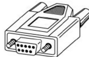
9-контактный последовательный тест-разъем
