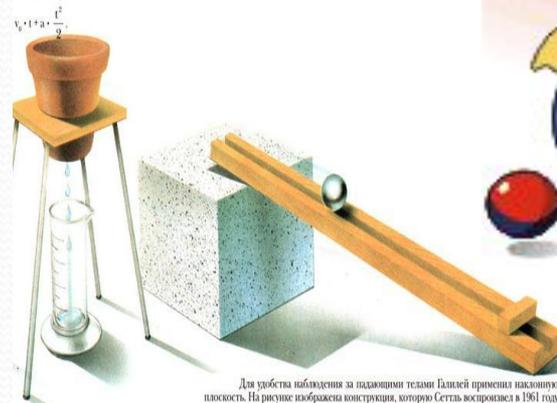
Для удобства наблюдения за падающими телами Галилей применил наклонную плоскость. На рисунке изображена конструкция, которую Сеттль воспроизвел в 1961 году по описанию, составленному великим физиком. Для измерения времени использовалась вода, которая сочилась из цветочного горшка через донное отверстие.
