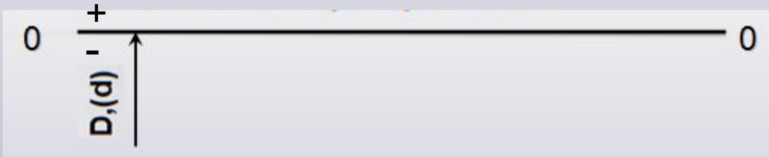
**Нулевая линия** – линия, соответствующая номинальному диаметру.
