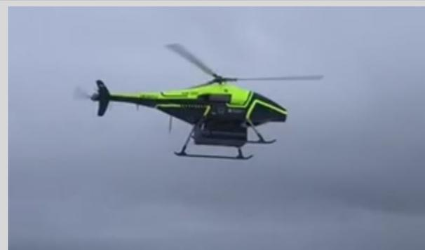
В декабре 2021 года на аэродроме Орловка (Тверская обл.) «БАС-200» выполнил демонстрацию аэрогравиметрических работ в интересах компаний ТЭК. Целевая нагрузка – аэрогеофизический комплекс разведки **массой 31 кг**.
