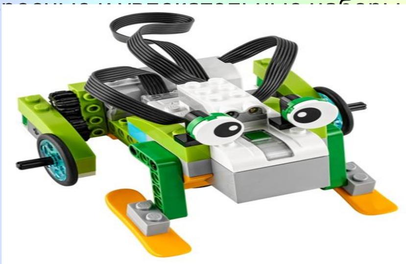
Собираемые роботы из ЛЕГО представлены моделью **ЛЕГО WeDo** (что в переводе означает «мы делаем»). Данный конструктор позволяет строить модели машин и животных, программировать их действия и поведение.
