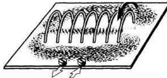
**Соленоид** (от греч. *solen* — трубка и *eidos* — вид) — проволочная спираль, по которой пропускают электрический ток для создания магнитного поля.
