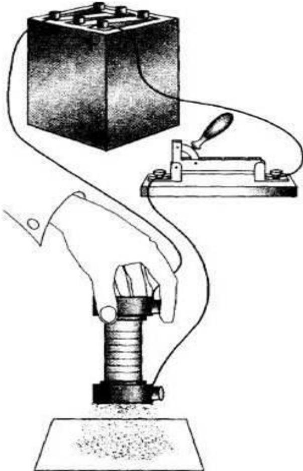
**Катушка, состоящая из большого числа витков провода, намотанного на деревянный каркас. Когда в катушке есть ток, железные опилки притягиваются к ее концам, при отключении тока они отпадают.**
