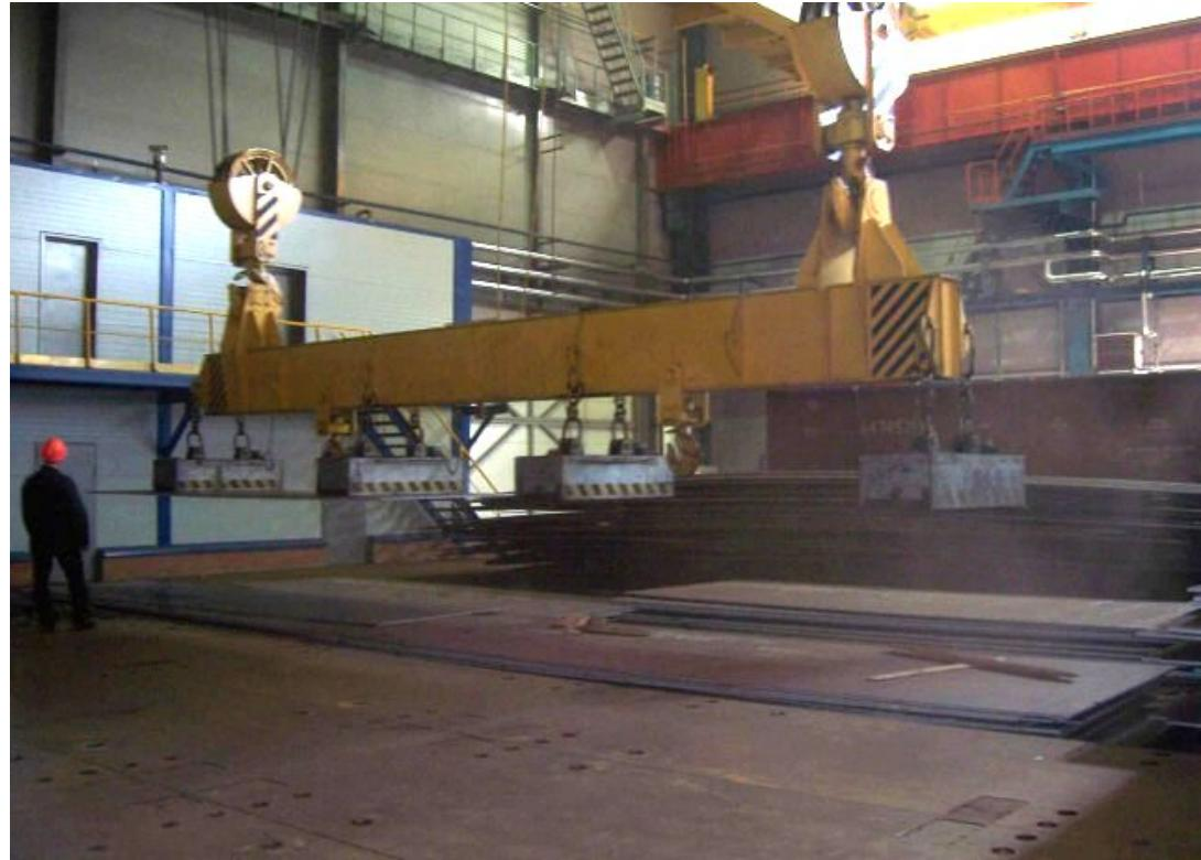
**Электромагнитные траверсы используются для перемещения длинномерных грузов.**
