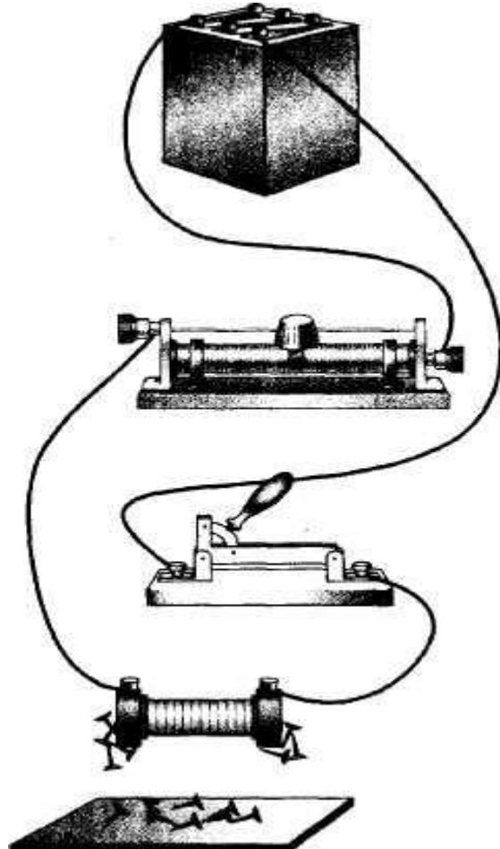
**Включим в цепь, содержащую катушку, реостат (см. рис.) и при помощи него будем изменять силу тока в катушке.**
