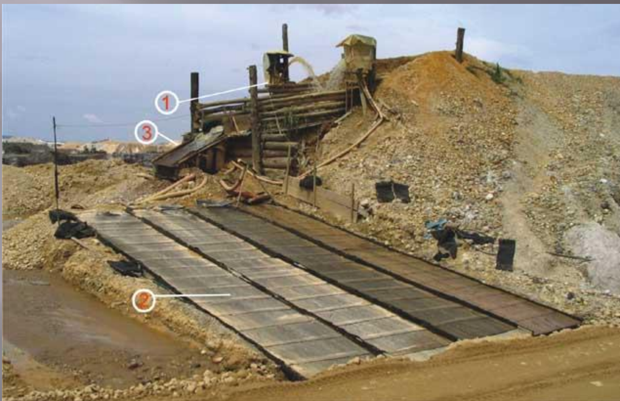
Рис.1 Общий вид промывочного прибора: 1-приемный бункер; 2-шлюзы мелкого наполнения; 3-колосниковый грохот
