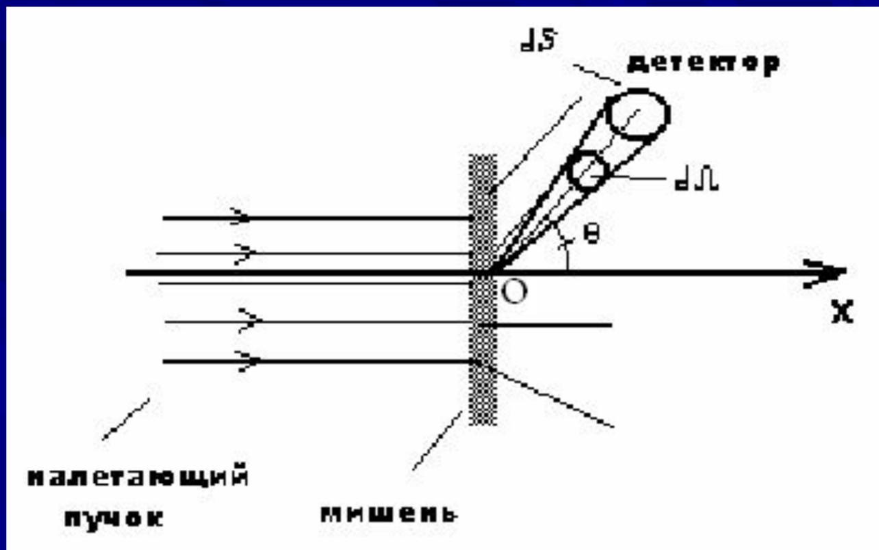
$O$  - центр рассеяния (ядро атома). Детектор с площадью рабочей поверхности  $dS$  регистрирует частицы, рассеянные под углом  $\theta$  - (угол рассеяния), и летящие внутри телесного угла  $d\Omega$ .
