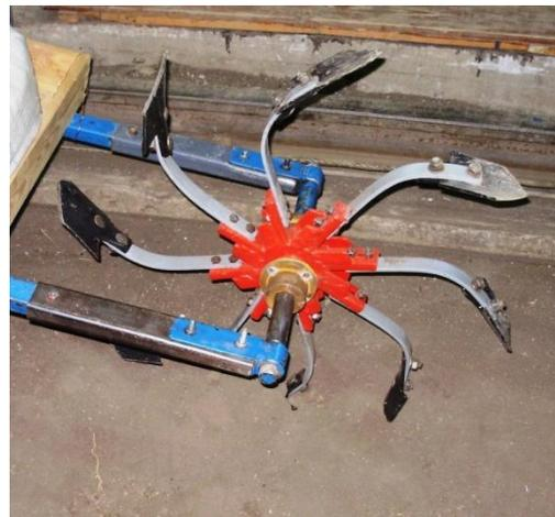
Испытания рабочего органа в почвенном канале
