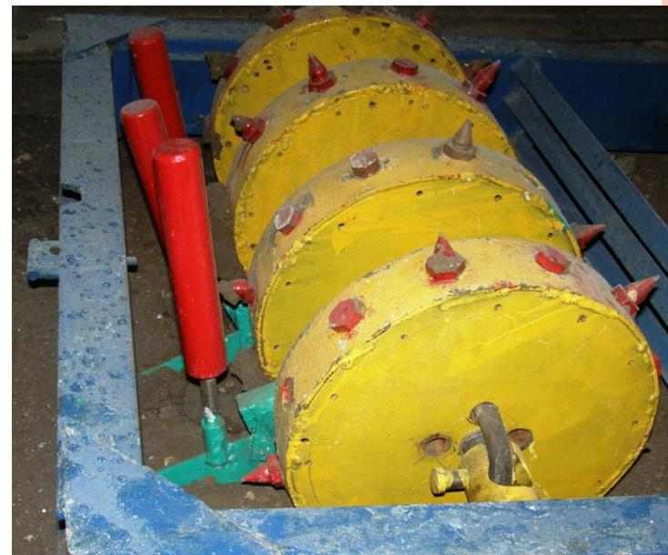
Испытания рыхлителя в почвенном канале
