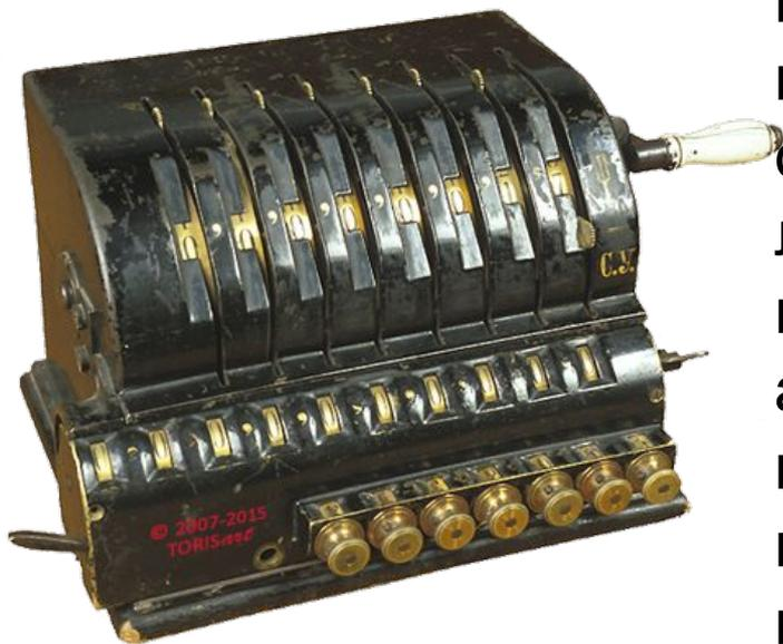
Числа вводятся в арифмометр, преобразуются и передаются пользователю (выводятся в окна счётчиков или печатаются на ленте) с использованием только механических устройств. При этом арифмометр может использовать исключительно механический привод (то есть для работы на них надо постоянно крутить ручку).
