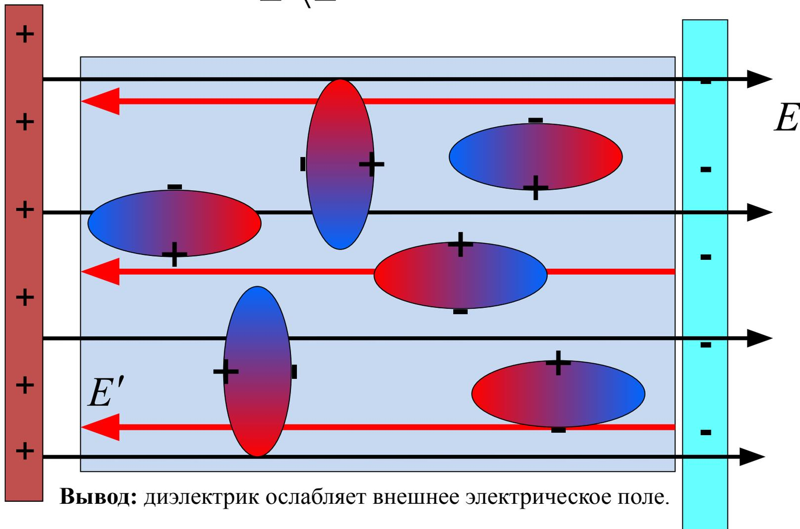
**Вывод:** диэлектрик ослабляет внешнее электрическое поле.
