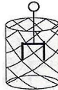
**Вывод:** внутри проводника электрического поля нет. Весь статический заряд проводника сосредоточен на его поверхности
