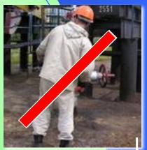
При снятии заглушки не допустимо нахождение оператора вдоль оси патрубка эхолотирования.
