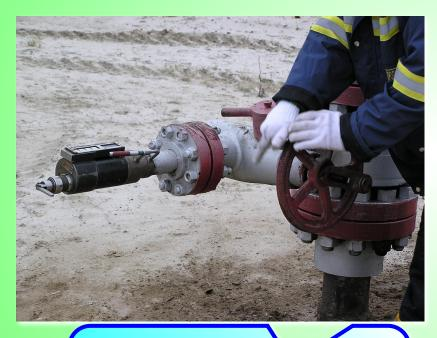
Снять окончательный результат, и занести в память прибора. Закрыть задвижку затрубного пространства
