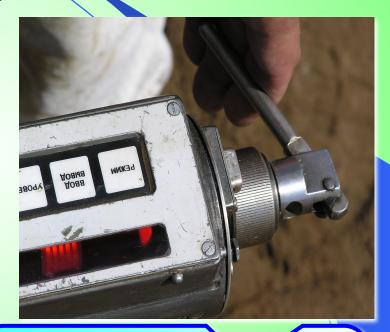
Стравить давление в приборе, выровнять давление в приборе до атмосферного путём нажатия выпускного клапана.
