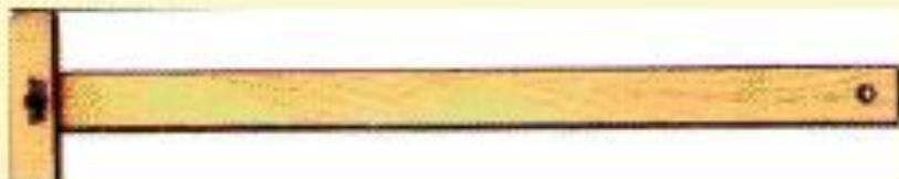
**Рейсшина** – служит для проведения параллельных линий
