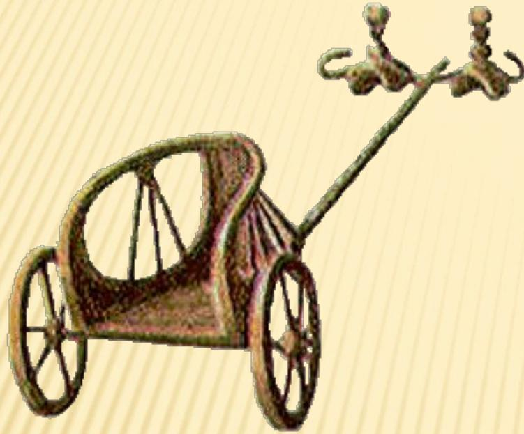
□ У колесницы было два колеса со спицами. На оси между колёсами укреплена площадка, где стояли двое – один управлял конями, а другой стрелял из лука и бросал в противников короткие копья – дротики. Площадка крепилась к длинной палке – дышлу, за которое два коня везли колесницу. Вся колесница, включая колёса и спицы, изготавливалась из прочного дерева. На площадке делались обтянутые кожей борта, чтобы защитить ноги возницы и стрелка.
