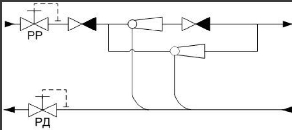
Отключение одного элеватора ведет к снижению расхода сетевой воды и повышению коэффициента смешения. Каждый элеватор может быть рассчитан на 50% расхода воды, либо один на 30-40%, а другой на 70-60%.
