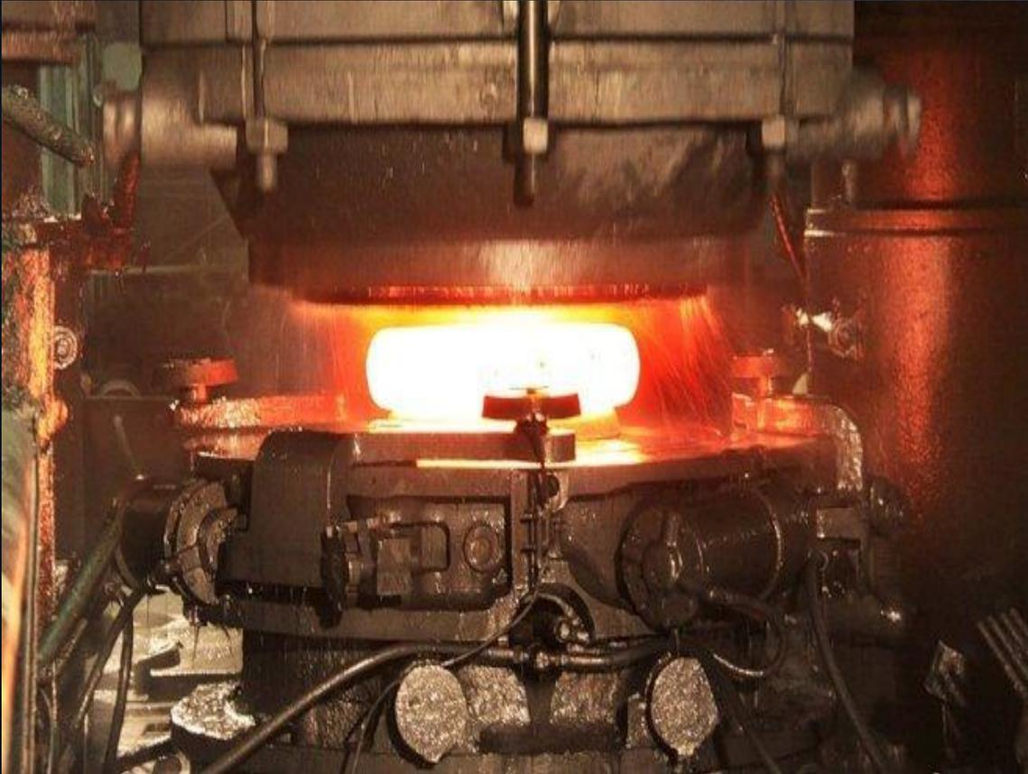
Такая технологическая операция, как ковка, относится к высокотемпературным методам обработки давлением. Перед началомковки металлическую деталь подвергают нагреву, величина которого зависит от марки металла, из которого она изготовлена
