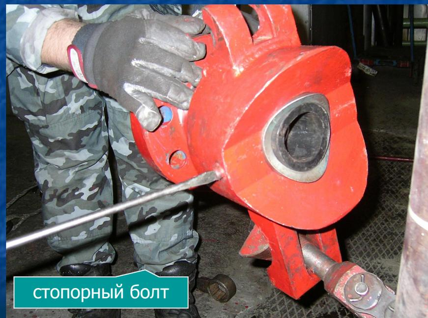
При креплении полухомута цепью натяжение цепи осуществляется болтом и гайкой
