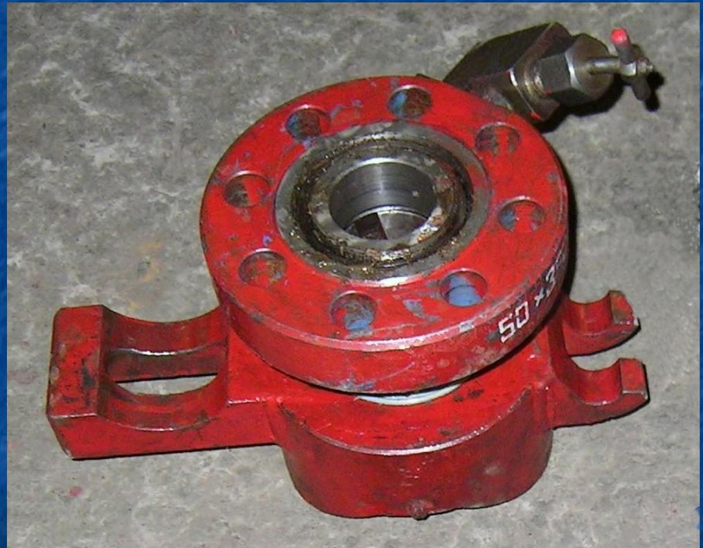
Состоит из полухомута со встроенным в него узлом герметизации места сверления, включающим в себя сменную оправку (втулку) и резиновый уплотнитель
