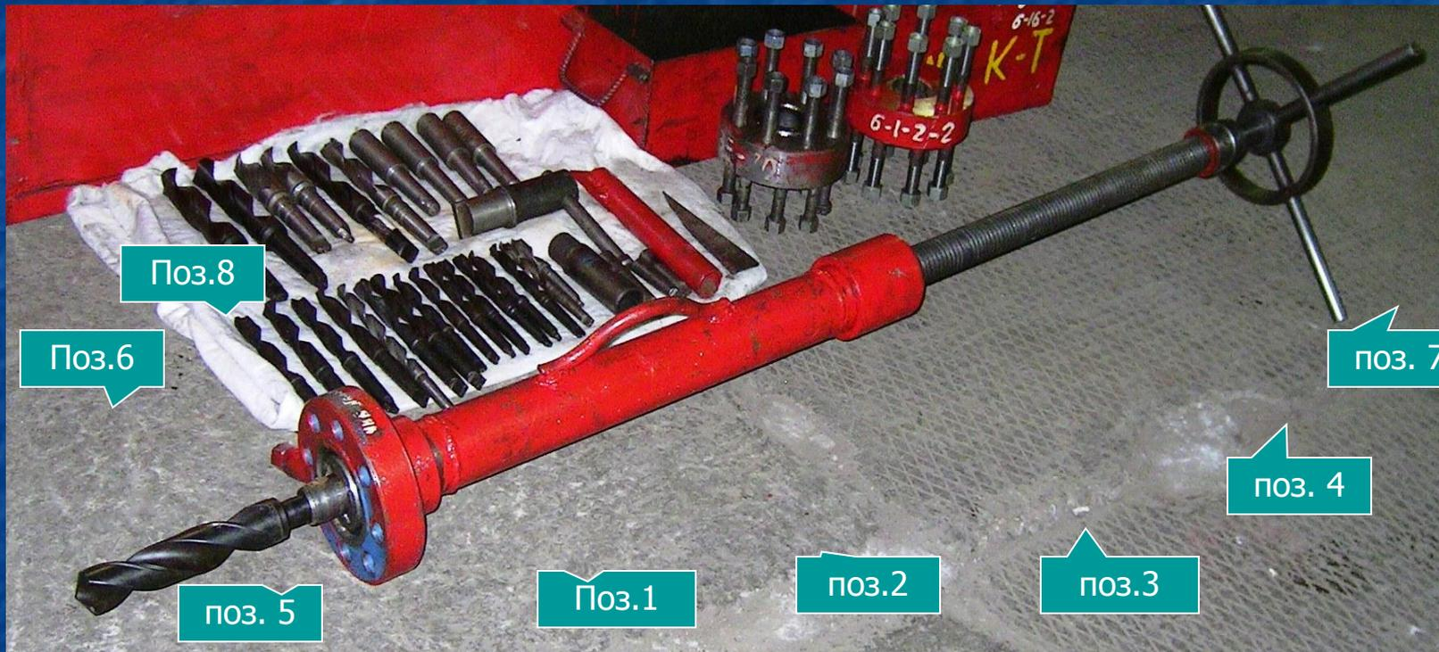
Состоит из фланца 1, корпуса 2, гайки 3, винта нажимного 4, шпинделя 5, сверла 6, штурвала 7
