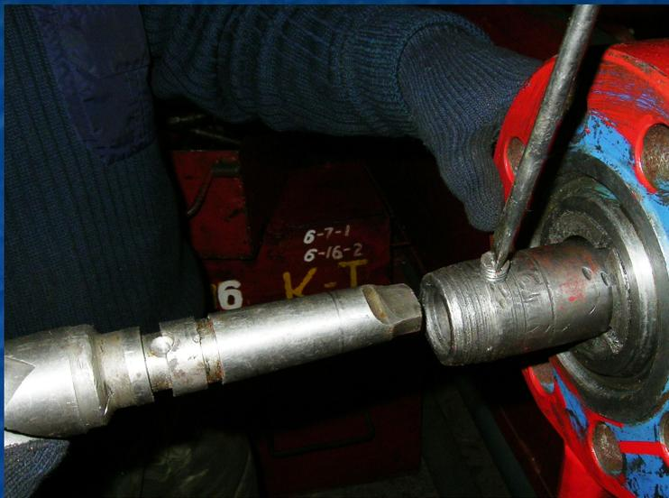
Присоединить к фланцу задвижки устройство сверления и прокрепить все элементы приспособления.
