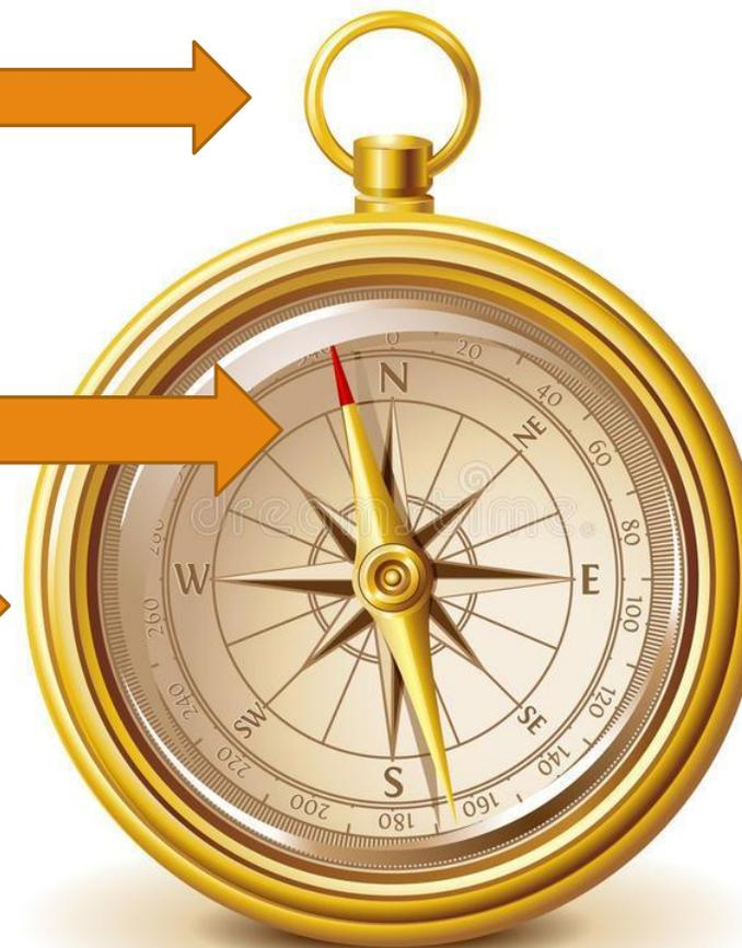
Чтобы определить стороны горизонта по компасу, нужно отпустить тормоз магнитной стрелки и установить компас горизонтально. Затем повернуть его так, чтобы северный конец магнитной стрелки оказался против буквы С, которая обозначает север. При таком положении буквы В, З и Ю укажут соответственно направления на восток, запад и юг. Теперь, только следует выбрать направление своего движения и соответствовать ему.
