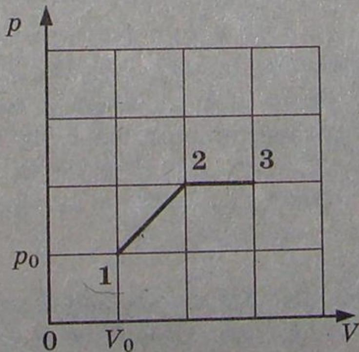
**С3.** Один моль одноатомного идеального газа совершает процесс 1–2–3 (см. рисунок, где  $T_0 = 100$  К). На участке 2–3 к газу подводят количество теплоты  $Q = 2,5$  кДж. Найдите отношение работы  $A_{123}$ , совершаемой газом в ходе процесса, к количеству теплоты  $Q_{123}$ , поглощенному газом.
