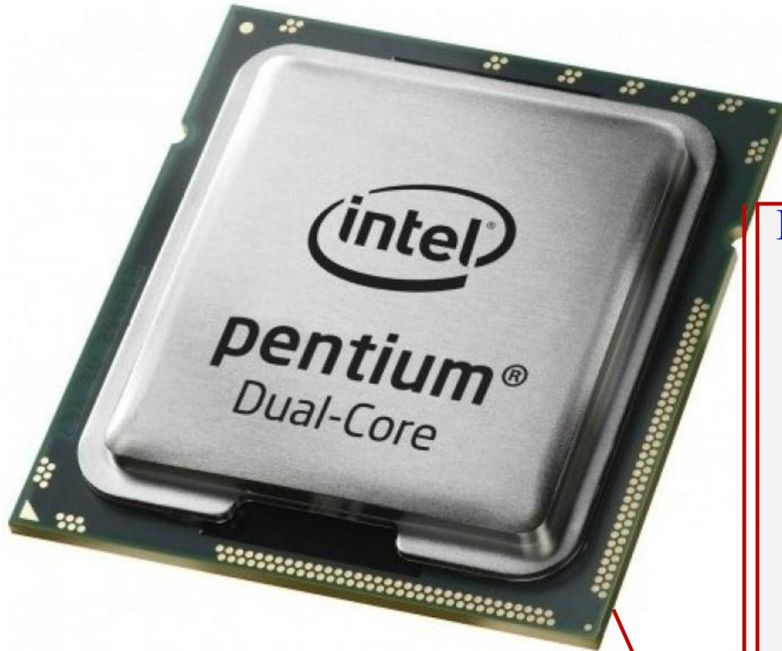
**Центральный процессор -** (англ. central processing unit, CPU, дословно - центральное обрабатывающее устройство) - электронный блок либо интегральная схема (микропроцессор), исполняющая машинные инструкции (код программ).
