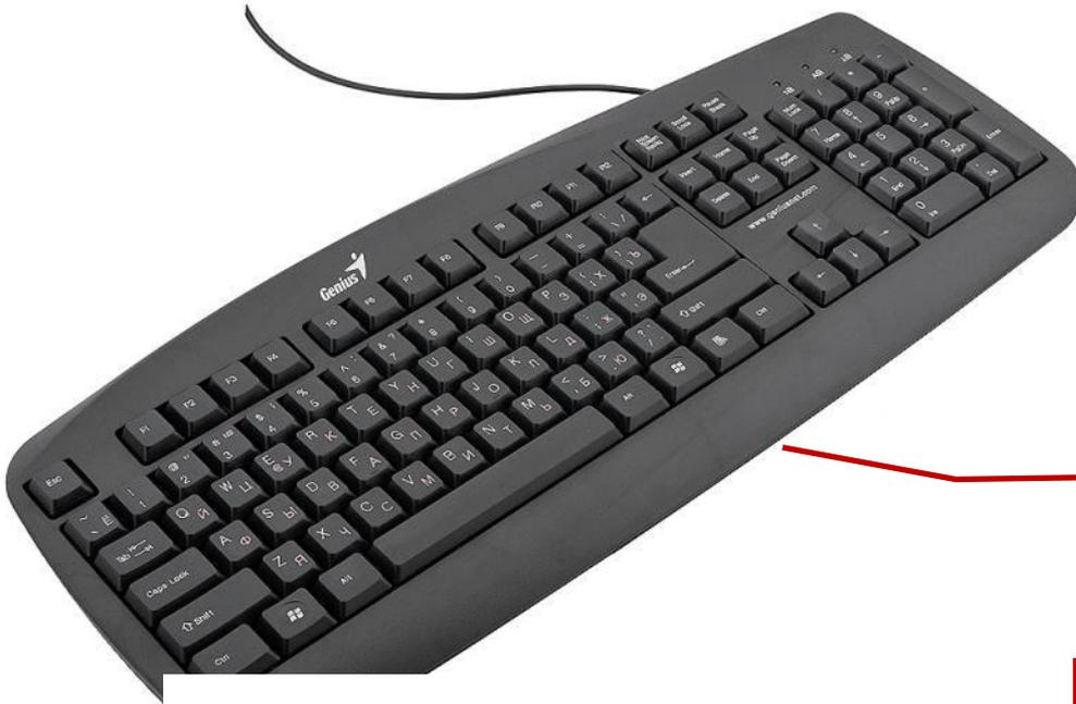
**Клавиатура** — устройство, позволяющее пользователю вводить информацию в компьютер. Представляет собой набор клавиш (кнопок), расположенных в определённом порядке.
