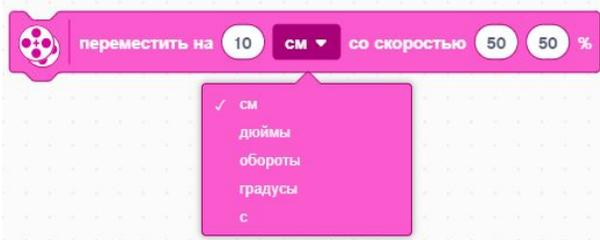
**Движение на определенное время с определенной скоростью:** Движение на указанное количество сантиметров, дюймов, секунд, градусов или оборотов с заданной скоростью для каждого мотора.
