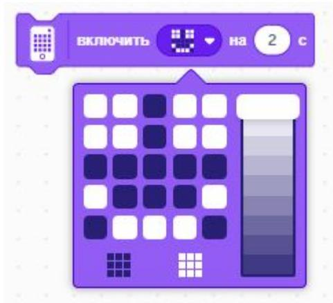
**Включить световую матрицу 5x5 на заданное время (в секундах):** Позволяет создать шаблон и включить его на световой матрице 5x5 на определенное время. Яркость пикселей регулируется с помощью ползунка.
