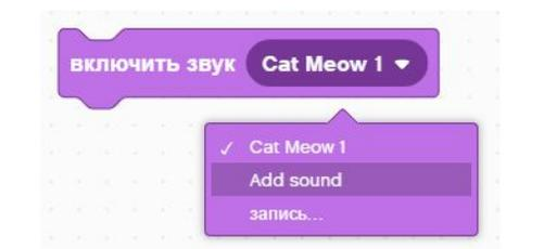
**Включить звук:** Воспроизводит определенный звук на устройстве и одновременно выполняет следующий блок текущей подпрограммы. Для того чтобы добавить звуки в проект, нажмите на кнопку «Добавить звук».
