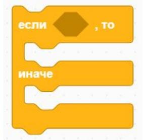
**Если...то...иначе:** Цикл проверяет, истинно ли логическое условие. Если условие истинно, воспроизводятся блоки, заключённые в первом пространстве. Если условие ложно, воспроизводятся блоки внутри второго пространства.
