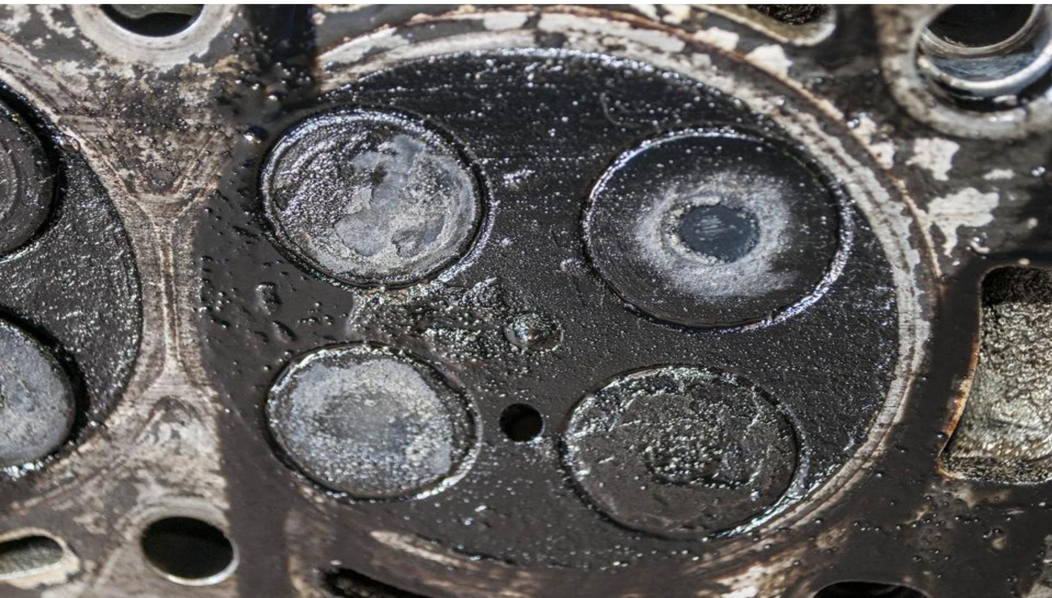
С повышением молекулярного веса углеводорода и температуры его кипения вероятность нагарообразования, как правило, увеличивается. Высококипящие ароматические углеводороды под воздействием высоких температур претерпевают окислительные превращения и, очевидно, служат основным источником образования нагара
