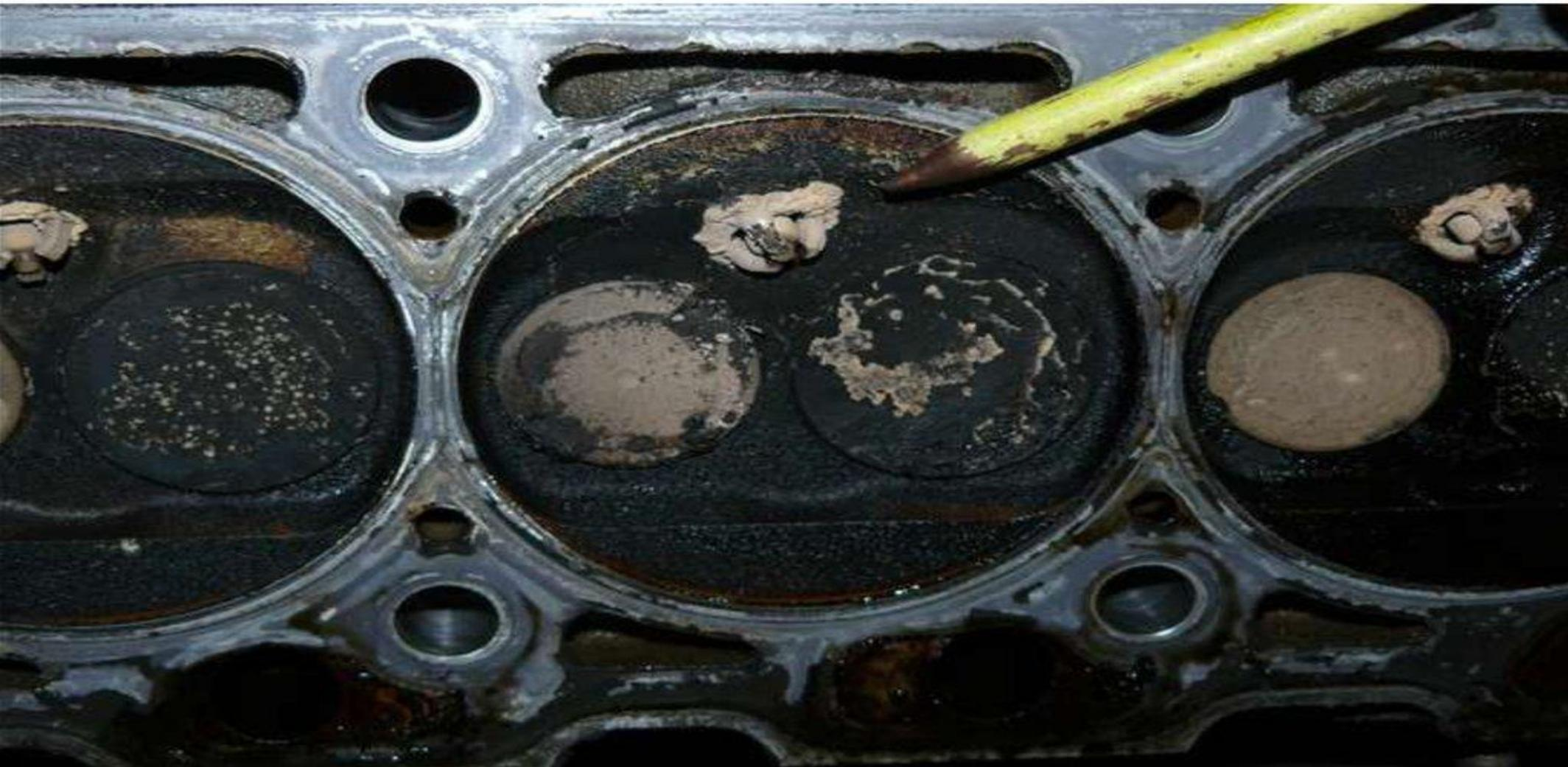
Ароматические углеводороды являются ценными составляющими автомобильных бензинов, так как обладают высокой детонационной стойкостью. Однако содержание их в товарных бензинах должно быть ограничено вследствие повышения нагарообразования в двигателе
