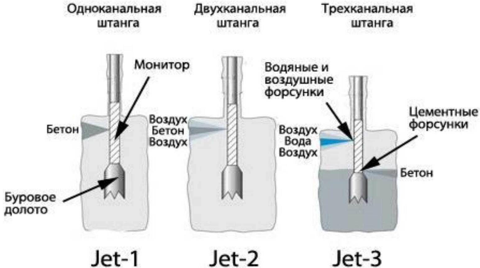
Главное отличие между тремя существующими системами струйной цементации – организация процесса разрушения грунта и создания грунтоцементных свай. Представленное на современном рынке буровое оборудование для позволяет выполнять разрушение грунта и формирование свай с помощью:
