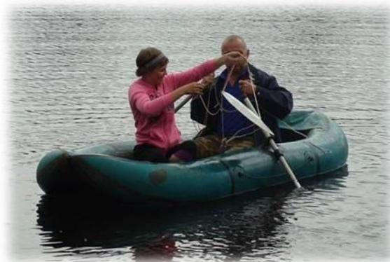
Определение прозрачности воды с помощью диска Секки
