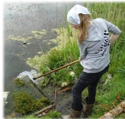
Взятие проб макрозообентоса с помощью скребка
