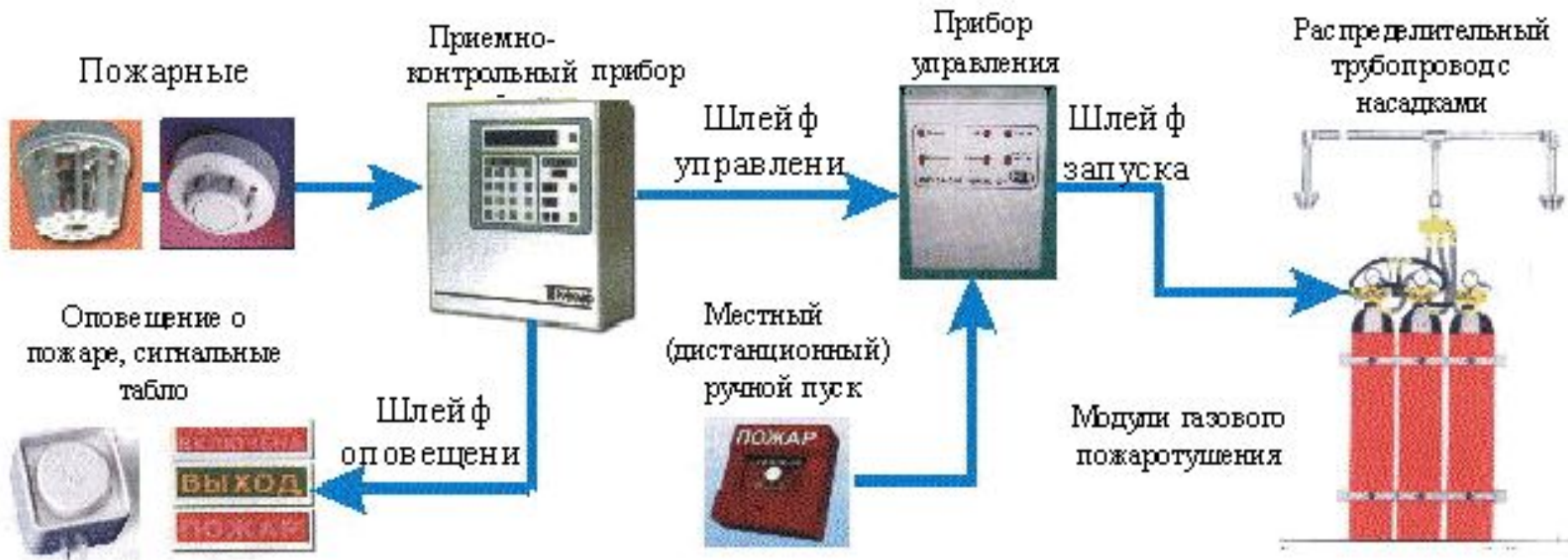
Структурная схема автоматической установки газового пожаротушения
