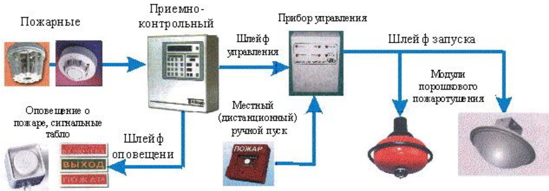
Структурная схема автоматической установки порошкового пожаротушения
