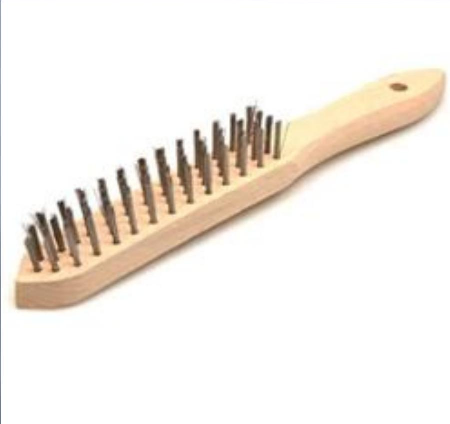
Заготовку очищают металлическими щетками от грязи, масла, окалины, затем обрабатываемую заготовку зажимают в тисках, опиливаемой плоскостью горизонтально на 8-10 мм выше уровня губок.
