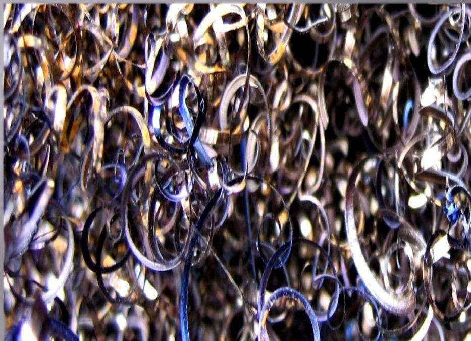
Отличительной особенностью процесса обработки на ленточнопильных станках является тонкий слой стружки, удаляемый каждым зубом пилы (от 0,5 до 20 мкм). Экспериментальные исследования показывают, что величина подачи на зуб, при обработке конструкционных сталей, должна лежать в пределах интервала от 7 до 8,5 мкм, при меньших подачах процесс резания затрудняется, стружка становится тонкой и порошкообразной, вместо резания начинает происходить процесс пластического
