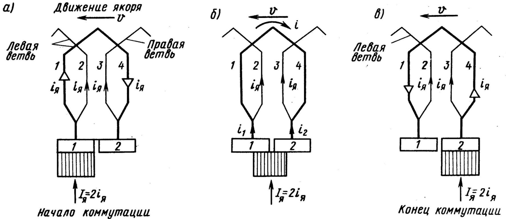
Рис. 113. Распределение тока в коммутируемой секции в различные моменты коммутации
