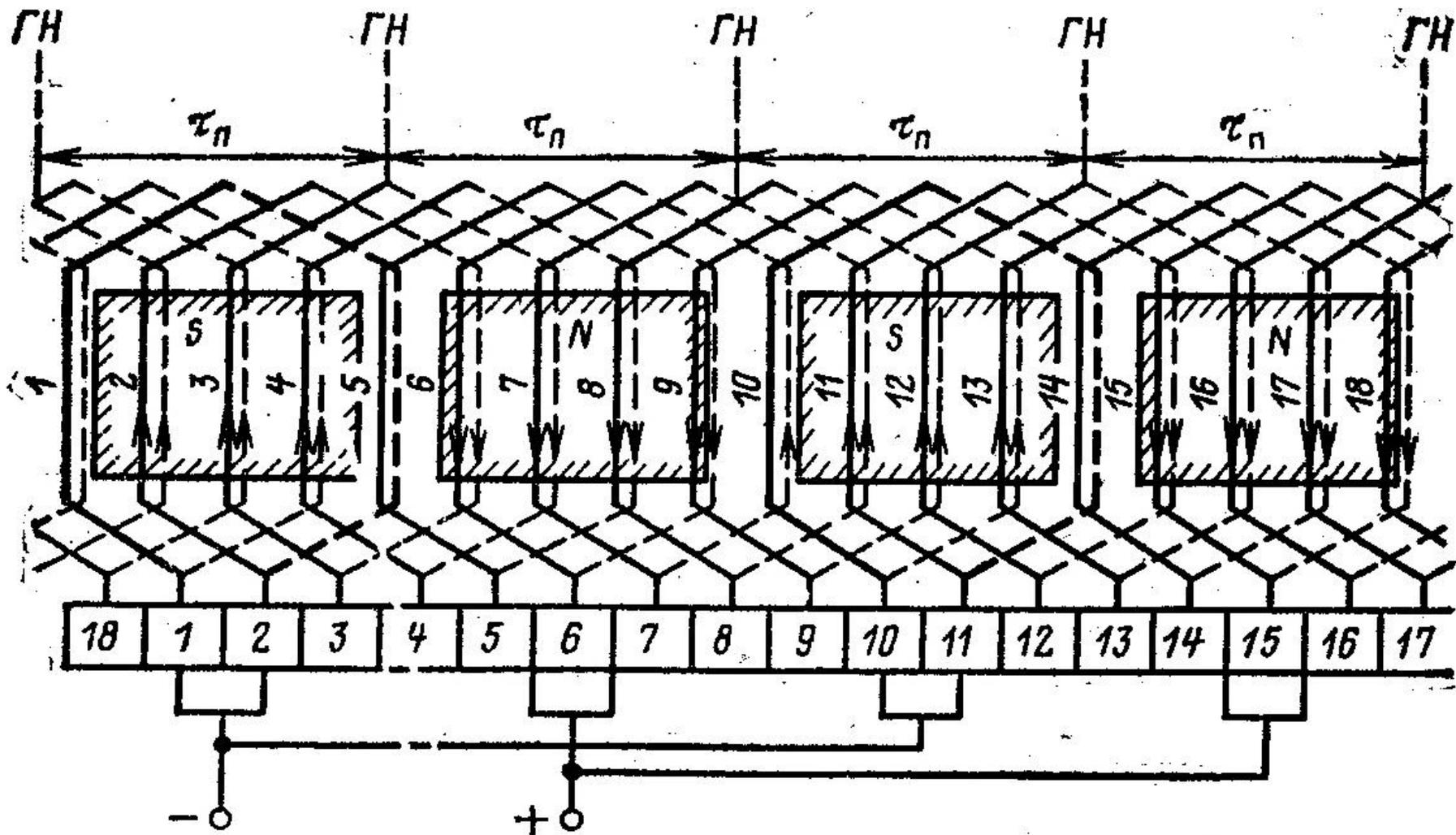
Рис. 2.5. Схема-развертка простой петлевой обмотки с  $Z_s = S' = K = 18$ ,  $2p = 4$
