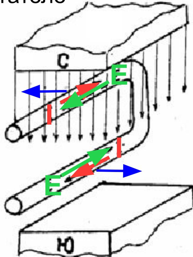
Сила, действующая на проводник с током в магнитном поле пропорциональна:
