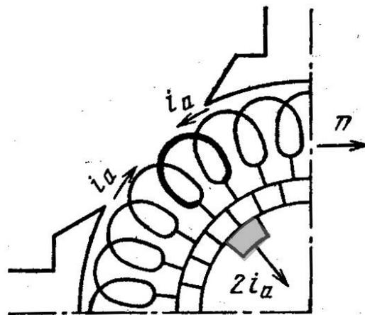
Рис. 6.1. Коммутация тока в секции
