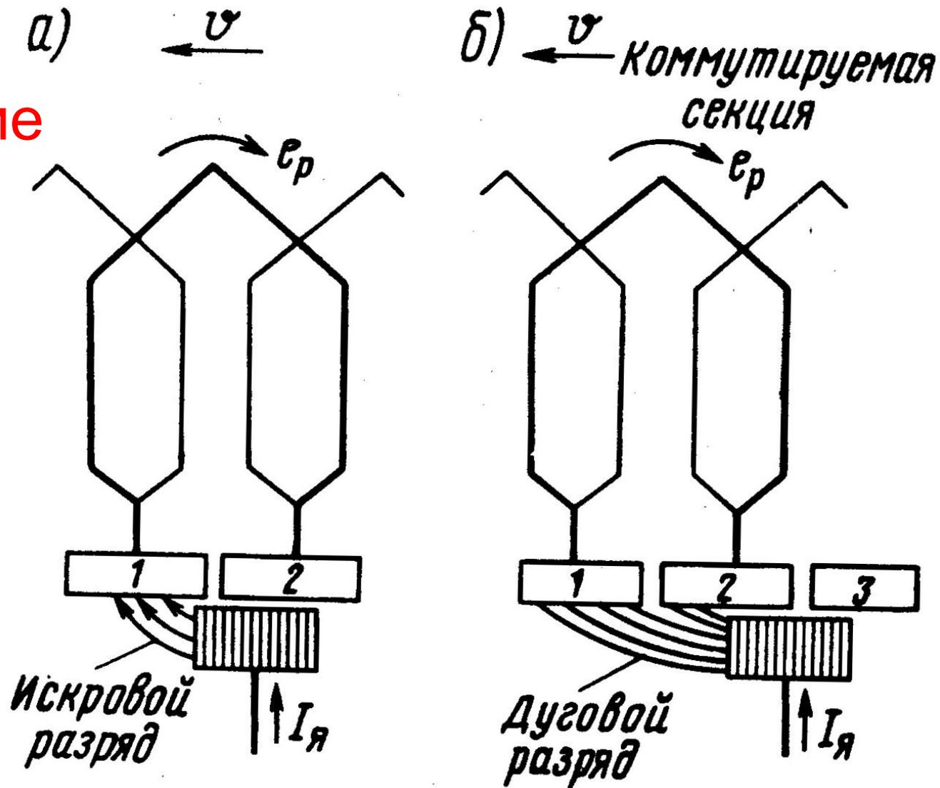
Рис. 116. Возникновение искрения под сбегающим краем при замедленной коммутации
