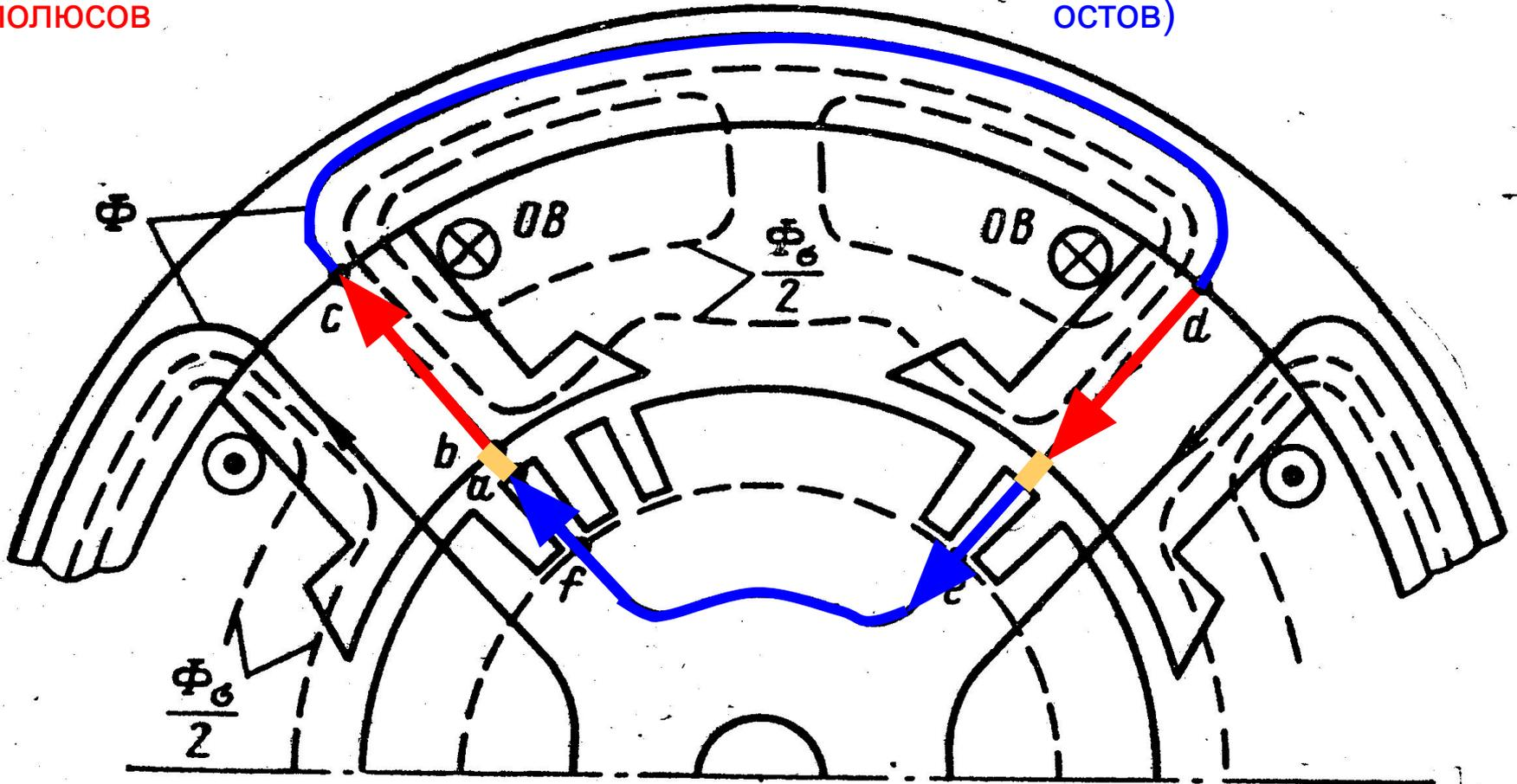
Воздушный зазор между сердечником ГП имеет большое магнитное сопротивление и значительно ослабляет магнитное поле
