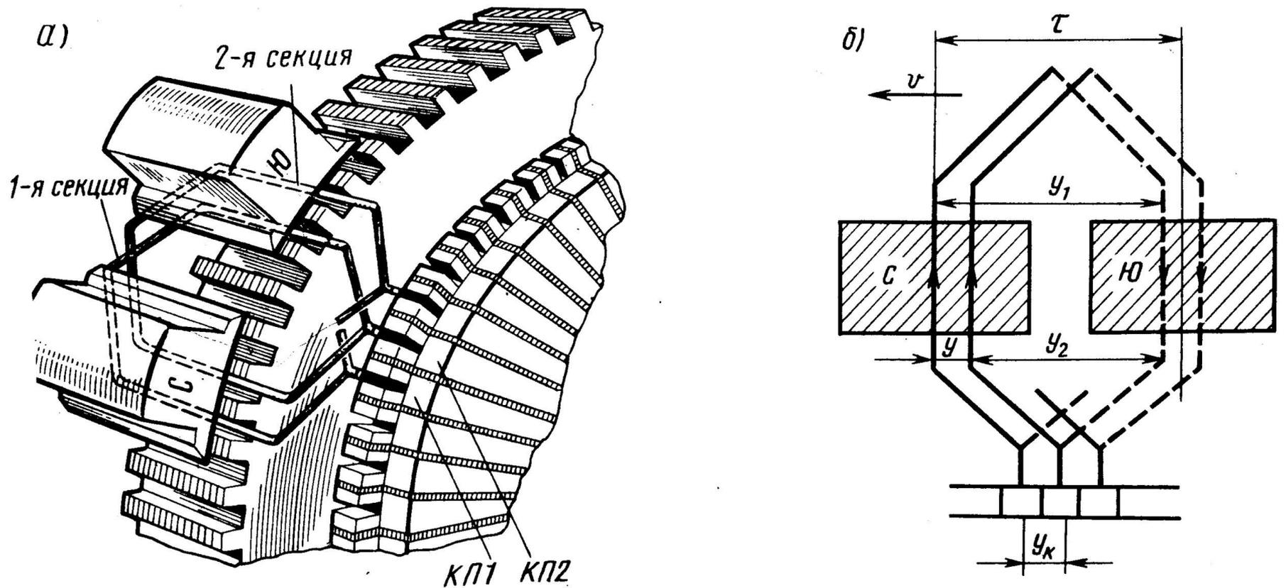
Рис. 97. Общий вид петлевой обмотки (а) и схема соединения ее секций (б)
