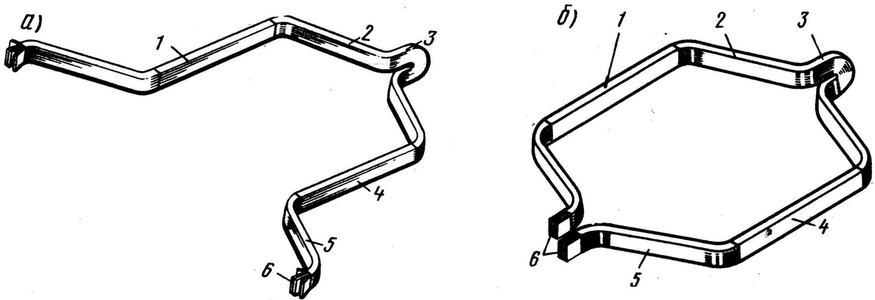
Рис. 95. Форма якорных катушек при волновой (а) и петлевой (б) обмотках:
