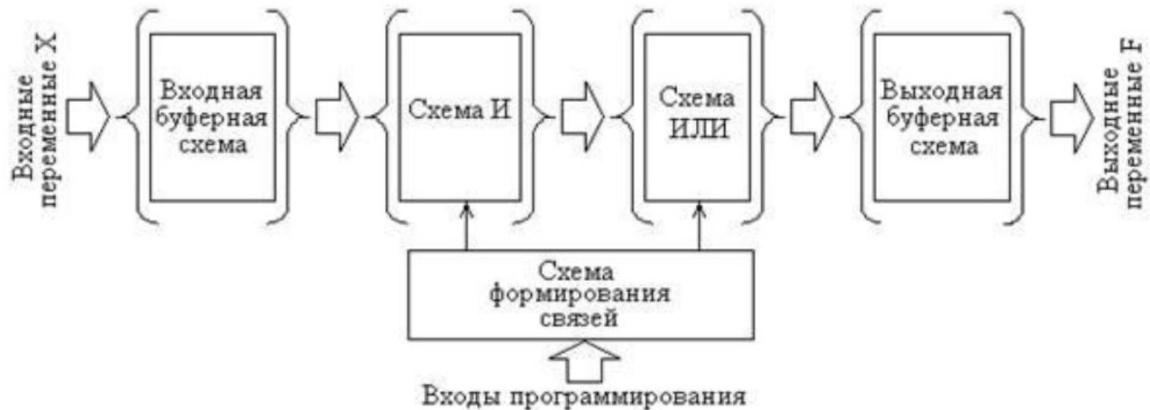
Рис.1 Обобщенная структурная схема ПЛИС.
