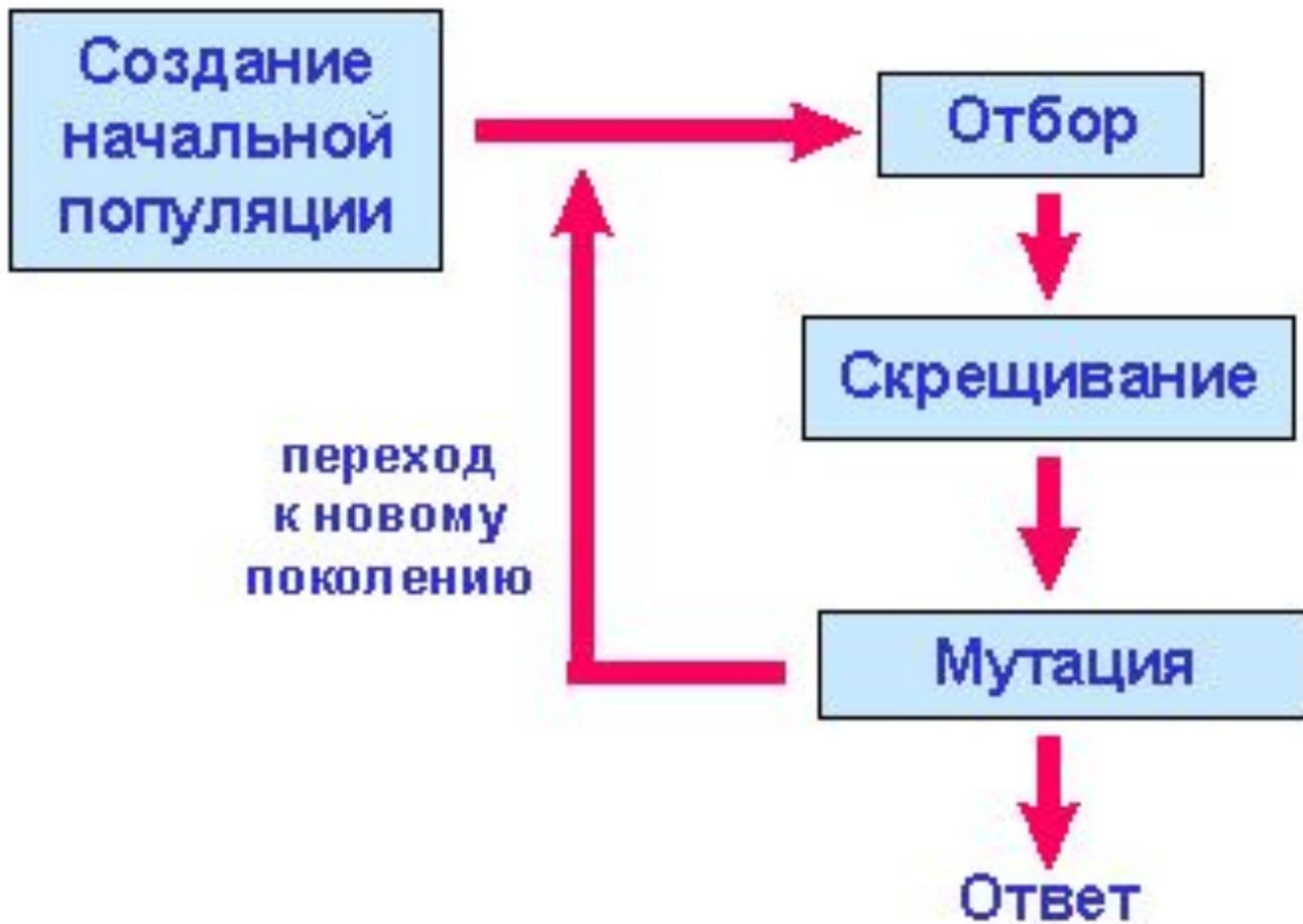
Рис.2. Блок-схема генетического алгоритма.
