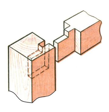
• Откладывание длины шипа по линейка
