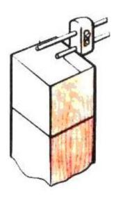
• Разметка толщины шипа рейсмусом
