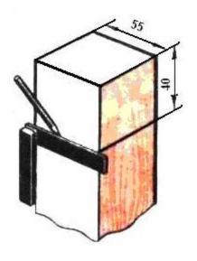
• Разметка толщины шипа рейсмусом
