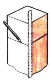
• Нанесение линии разметки по угольнику
