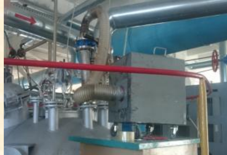
Обработка внутренней поверхности посевного ферментатора озono-воздушной смесью на ОАО «Скидельский сахарный комбинат»
