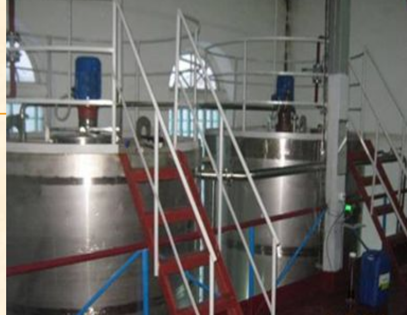
Инновационный участок водно-тепловой и ферментативной обработки зернового сырья при производстве этилового спирта
