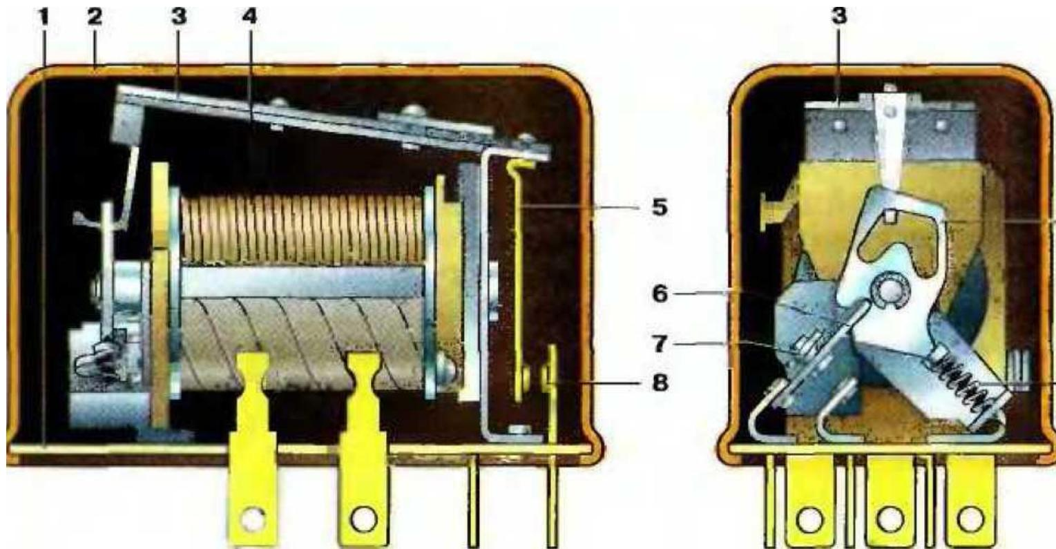
1 монтажная панель; 2 - крышка; 3 - якорь; 4 - обмотка; 5, 6 контактная пластина; 7 контакты переключения света фар; 8 - контакты сигнализации фарами; 9 - переключающее устройство; 10 - пружина
