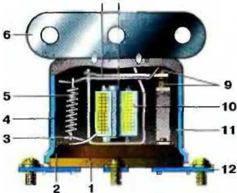
1 основание; 2 - уплотнительная прокладка, 3 стойка пружины; 4 крышка; 5 - пружина; 6 - кронштейн крепления реле; 7 - «корь»; 8 - сердечник обмотки; 9 - контакты 10 - обмотка; 11- ярмо. 12 - вывод
