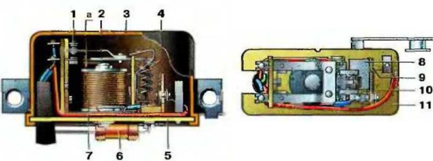
1 контакты: 2 - якорь; 3 - крышка; 4 - пружина; 5 оснований 6 - резистор; 7 – электромагнитное реле, 8 - стойка биметаллической пластины; 9 - биметаллическая пластина; 10 - обмотка; 11 - стойка неподвижного контакта; с - зазор между якорем и сердечником
