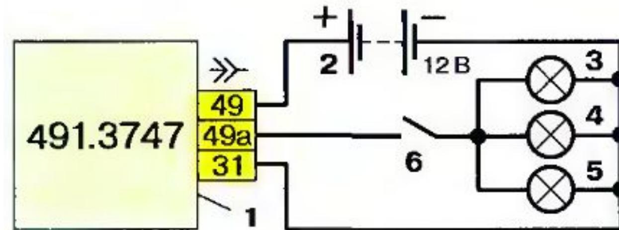
1 - реле- прерыватель; 2 аккумуляторная батарея; 3, 4, 5 - контрольные лампы; 6 - выключатель
