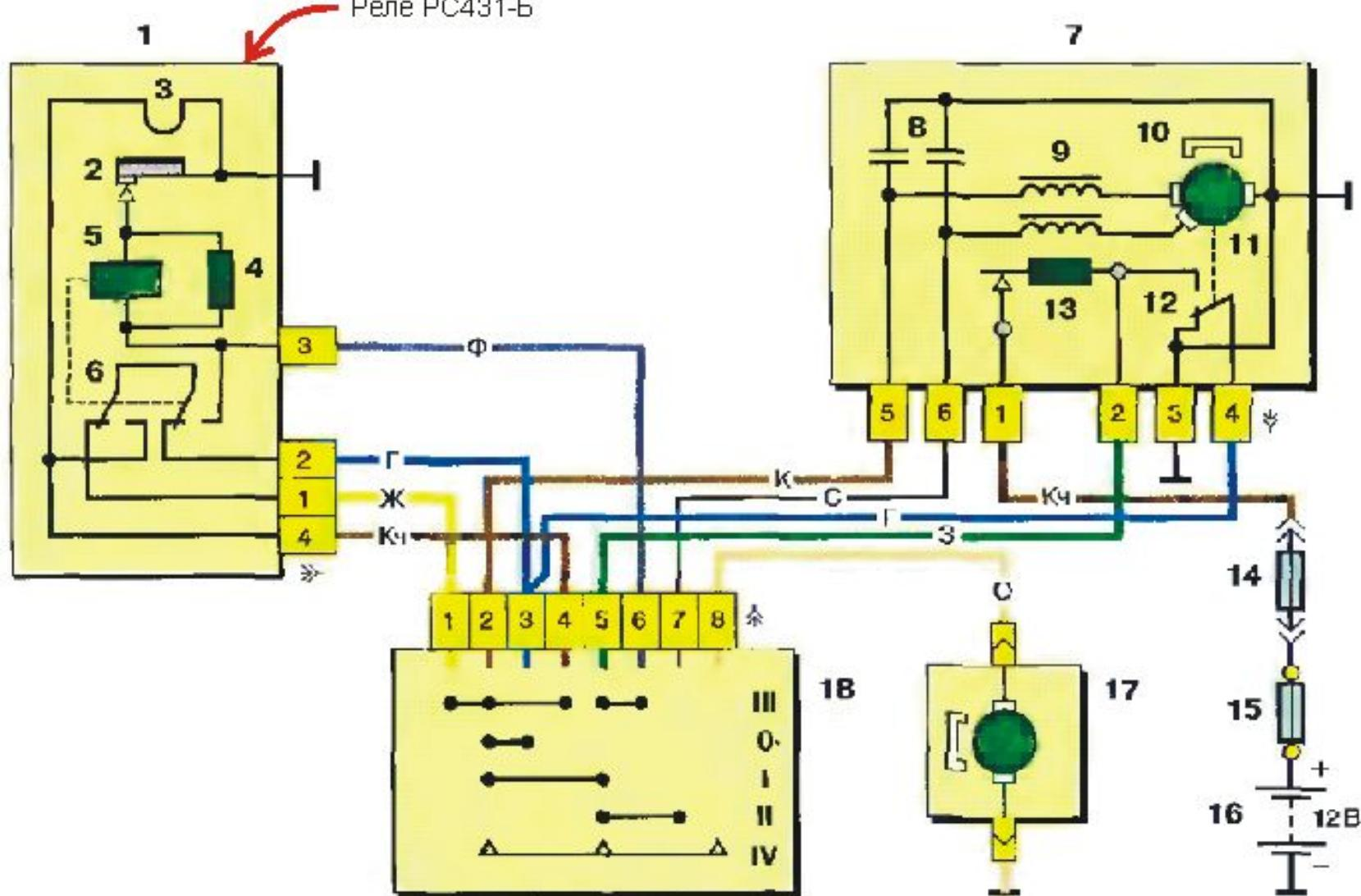
1 реле PC431-Б; 2 биметаллическая пластина; 3 - обмотка; 4 - резистор; 5 - обмотка реле; 6 - контакты реле; 7 электродвигатель стеклоочистителя; 8 - конденсаторы; 9 - фильтр радиопомех; 10 - постоянный магнит, 11 - якорь электродвигателя стеклоочистители; 12 - концевой выключатель; 13 - биметаллический предохранитель, 14 - предохранитель на 10 А; 15 - предохранитель на 60 А; 16 - аккумуляторная батарея; 17 - электродвигатель омывателя; 18 переключатели
