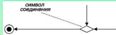
Для объединения альтернативных ветвей также используется символ в форме ромба, который в этом случае называют **соединением** (merge). Входящих стрелок у символа **соединения** (слияние) может быть несколько. Выходить из **соединения** может только одна стрелка.
