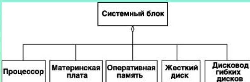
Диаграмма классов для иллюстрации отношения *агрегации* на примере системного блока ПК
