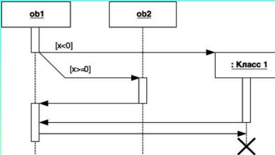
Для изображения *ветвления* используются две или более стрелки, выходящие из одной точки *фокуса управления объекта*. При этом рядом с каждой из них должно быть указано соответствующее *условие ветви* в форме *булевого выражения*.
