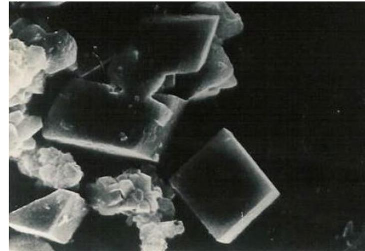
Фотографии со сканирующего электронного микроскопа кристаллов  $\text{CaCO}_3$  x 1000
