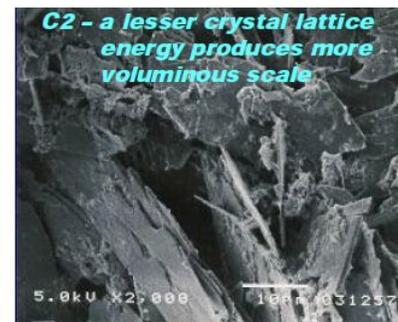
Выпадение осадков  $\text{Ca}(\text{OH})_2 + \text{H}_3\text{PO}_4$  с использованием аналога FLOWMAG, поддерживающего заданный коэффициент турбулентности
