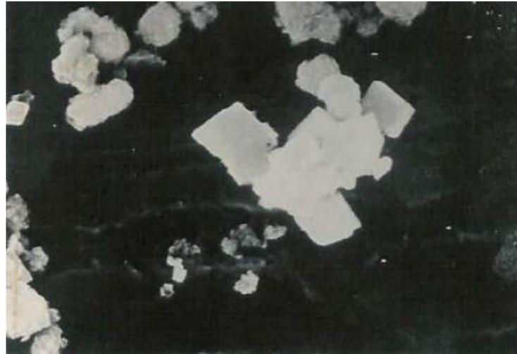
Кристаллы карбоната кальция, образовавшиеся в трубе vaporизатора с использованием FLOWMAG.
